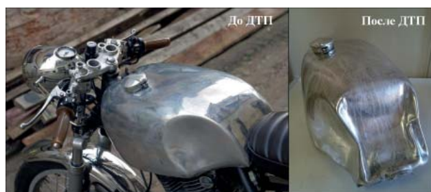
Рис. 12. Внешний вид бензобака мотоцикла “Yamaha SR 400 Cafe Racer” Fig. 12. Yamaha SR 400 Cafe Racer gas tank
